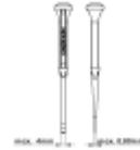
3) Verwenden Sie einen Schraubendreher mit einer Klinge von max. 4x8mm
