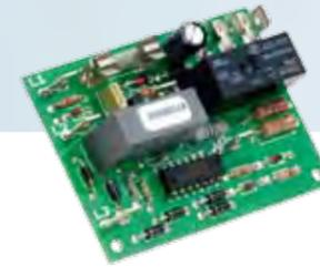
Drehrichtungsüberwachung mit Phasenausfallerkennung
