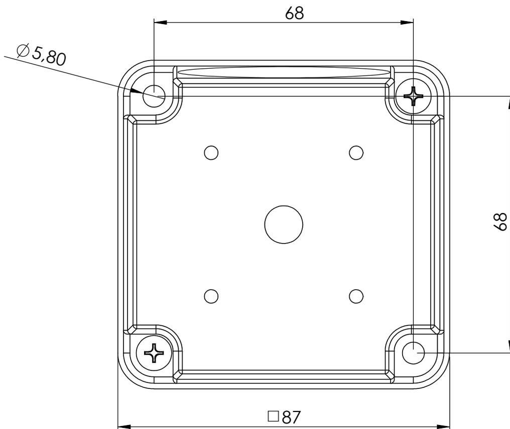
max. Schaltereinbauhöhe: 98 mm
