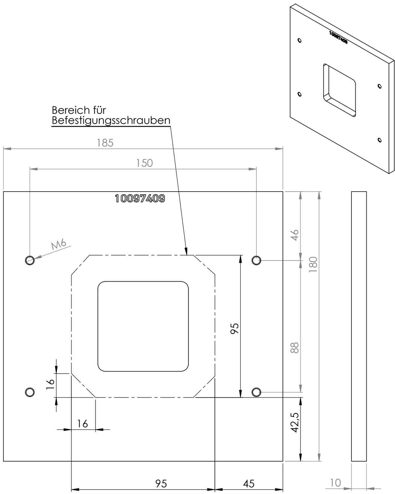
Wenn die Befestigungsbohrungen außerhalb der angegebenen, schematisch dargestellten Positionen gesetzt werden, so muss der Schraubenkopf versenkt, oder Senkschrauben verwendet werden.
